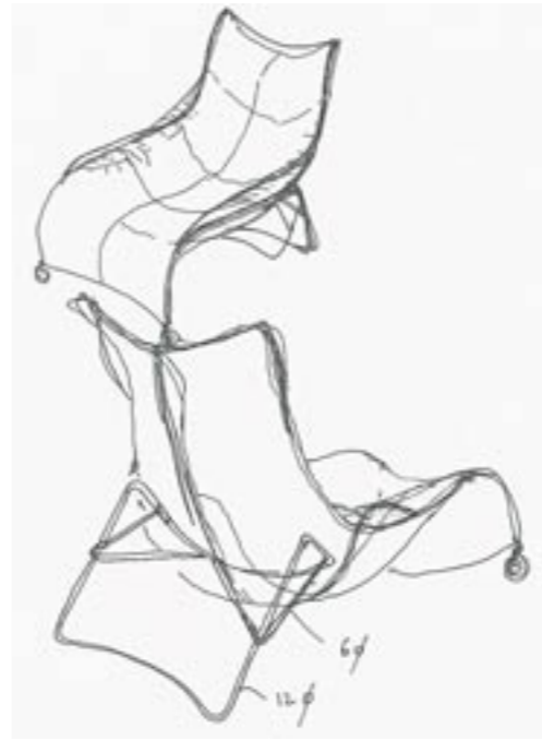
Chaise-longue di B & B, design Antonio Citterio. Due posizioni per il comfort: la seduta in cuoio, con struttura in acciaio cromato, può scivolare passando dalla angolazione per la lettura a quella per il relax
